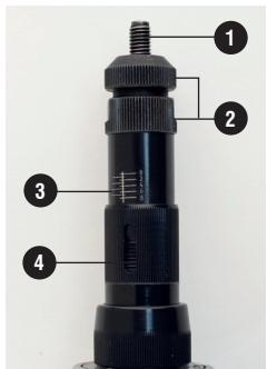
En fonction de l'écrou et de l'épaisseur du support, le réglage de la course est nécessaire pour un sertissage optimal.
