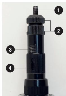
In base all'inserto filettato e allo spessore da serrare, regolare la corsa affinché il serraggio sia ottimale.
