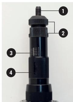
W zależności od używanej nitonakrętki i grubości materiału skok należy wyregulować, aby zoptymalizować montaż nitonakrętki.
