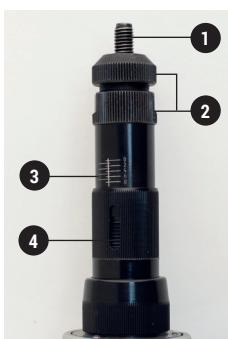
Podle nýtovací matice a tloušťky materiálu musí být zdvih přizpůsobený pro optimální instalaci nýtovací matice.
